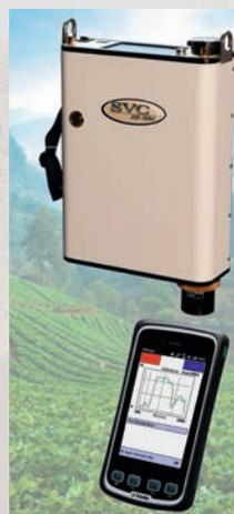
▲ Exemple d'un spectroradiomètre portable récent (SVC HR-768si) mesurant la réflectance dans la gamme visible à moyen infrarouge.
